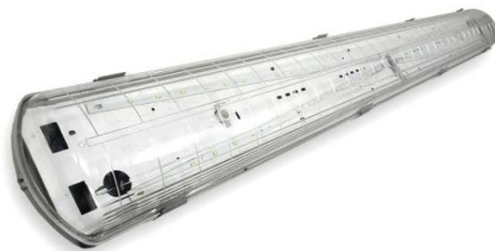
Корпус предназначен для производства светодиодных растровых светильников типа ЛСП 2х36. Конструкция корпуса обладает степенью пыле- и влагозащиты IP65, что позволяет использовать его для освещения в помещениях промышленного назначения. Корпус является разборным и имеет потолочные крепления, что облегчает монтаж и обслуживание.
